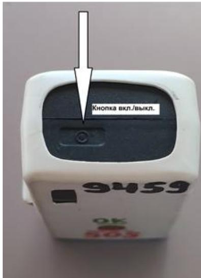
Прибор имеет встроенный аккумулятор. Кабель USB Type-C (выдается на регистрации) должен быть подключен к бортовому питанию автомобиля ознакомления для осуществления подзарядки на протяжении всего времени ознакомления с маршрутом ралли.
