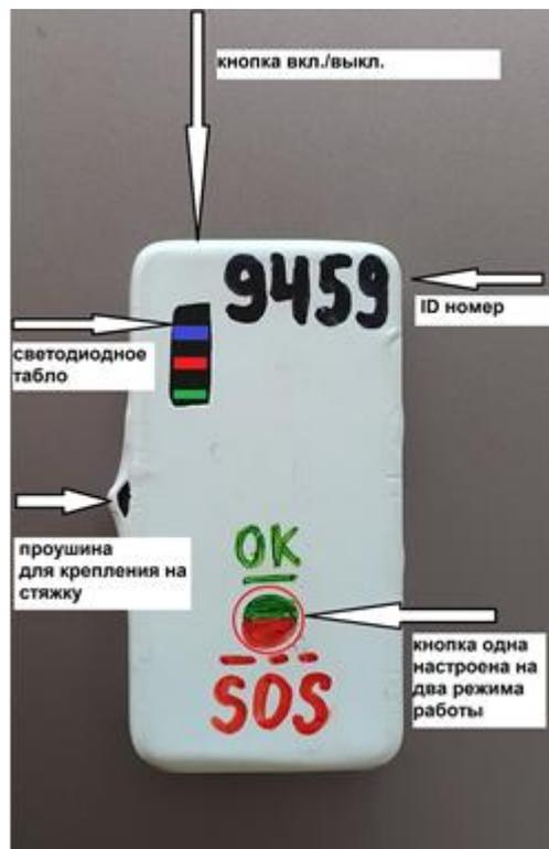
Устройство имеет ОДНУ кнопку, настроенную на подачу сигналов «OK» и «SOS».
